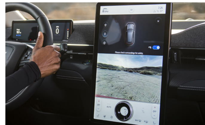
SYSTEM KAMER 360 STOPNI
